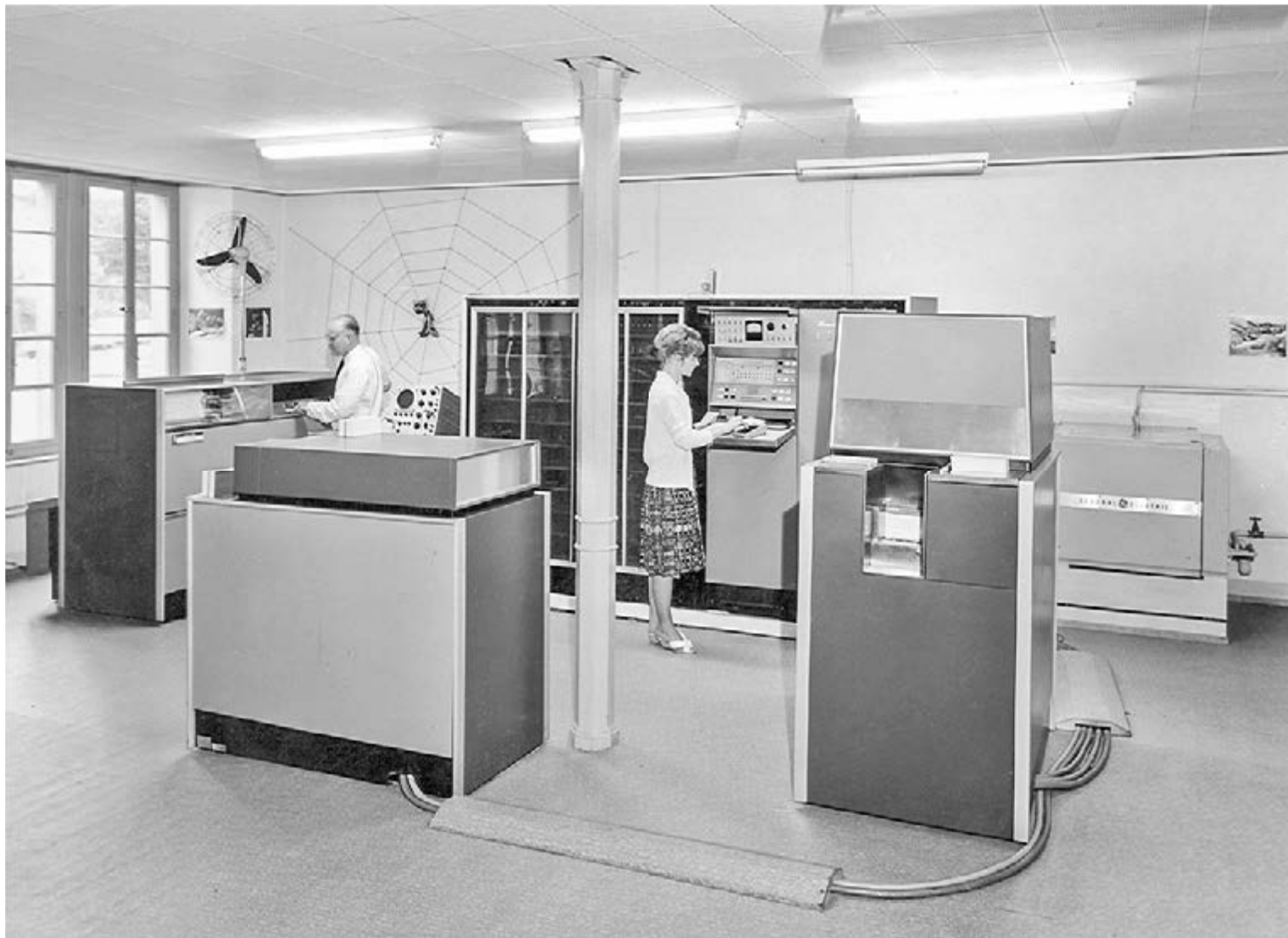
121 Das 1963 im Gebäude von Gänsslen-Landolt installierte UNIVAC-UCT-System. Neben der Zentraleinheit mit 5000 Speicherstellen (Magnet-Trommelspeicher) gehörte auch ein Lochkartenleser (vorne links), ein Lochkartenstanzer (vorne rechts) sowie ein Drucker (hinten links) zum System.
