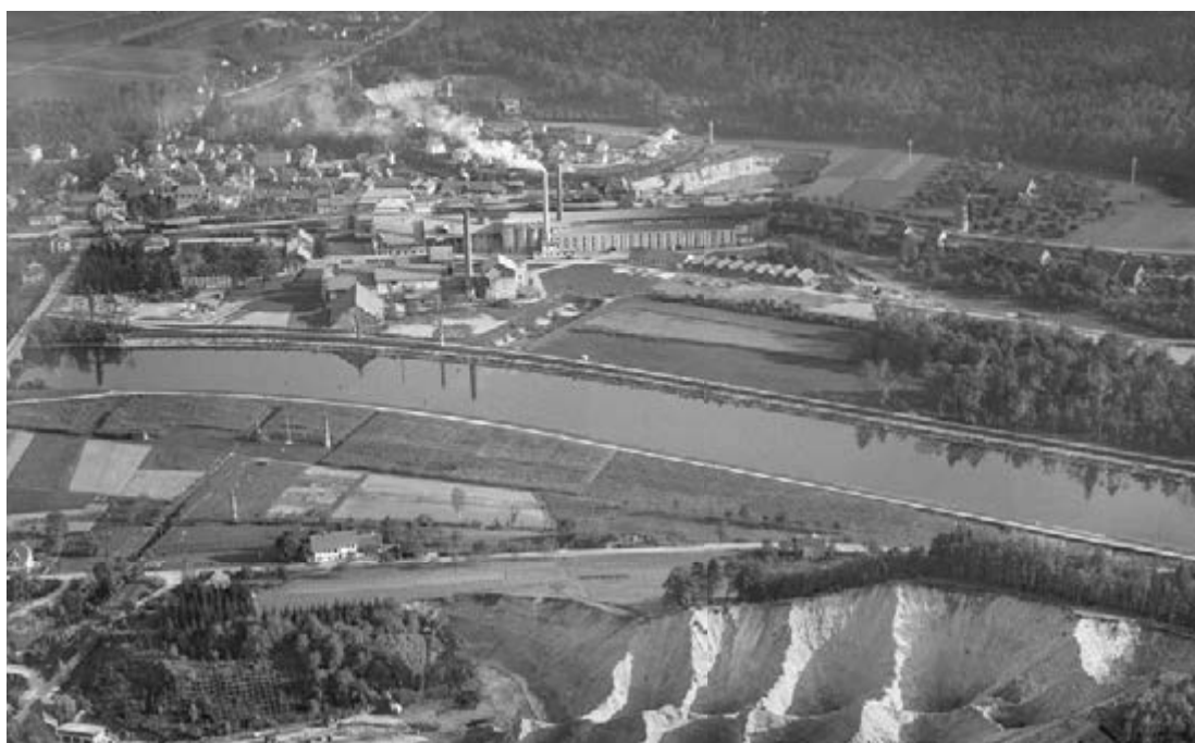
273 Flugaufnahme der Jura-Cement-Fabrik Wildeggen, 1948. Die zentrale Lage mit Bahnanschluss und der Rohstoffreichtum des Jura-Gebirges führten zur Ansiedlung von Zementwerken in Wildeggen, Holderbank und Würenlingen. Problematisch waren die Schadstoffe in den Rauchfahnen, welche sich in hoher Höhe verteilten, bis der Einbau von Filtern 1964 gesetzlich vorgeschrieben wurde.
