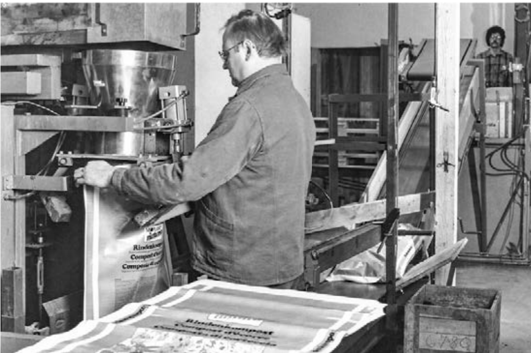
336a und b Die Anlage des Bioriko-Erdenwerks der Firma Häfeli-Brügger in Klingnau, 1970er-Jahre: Das Denken in Kreisläufen war naheliegend, als es darum ging, die Unmengen an Rindenabfällen der Spanplattenfabrik Novopan der Wiederverwertung zuzuführen. Aus dem gehäckselten Material in Rottenkörben entstand Rindenkompost für den Garten.
