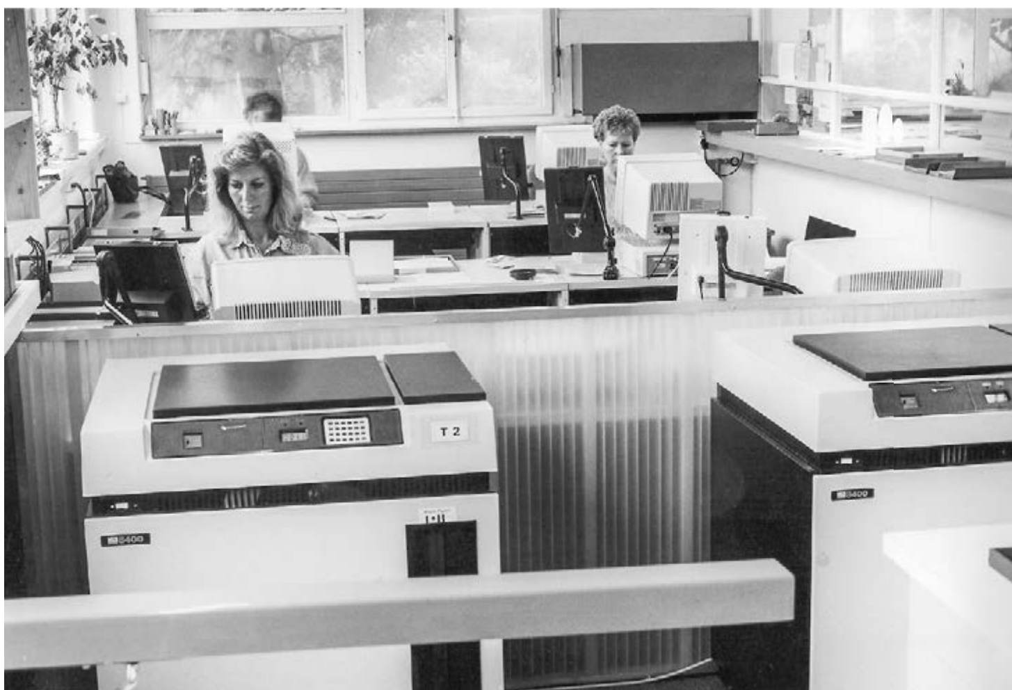
232 Blick in die Fotosatzabteilung des Wynentaler Blatts Ende der 1970er-Jahre, wo Tasterinnen die Texte erfassen; die weiteren Schritte der Zeitungsproduktion wurden von Typografen (Text) und Lithografen (Bildherstellung) erledigt. Ab Mitte der 1990er-Jahre hielten die Desktop-Computer Einzug, und die ganze Druckvorstufe mit Text- und Bildlayout wurde allmählich zusammengeführt.
