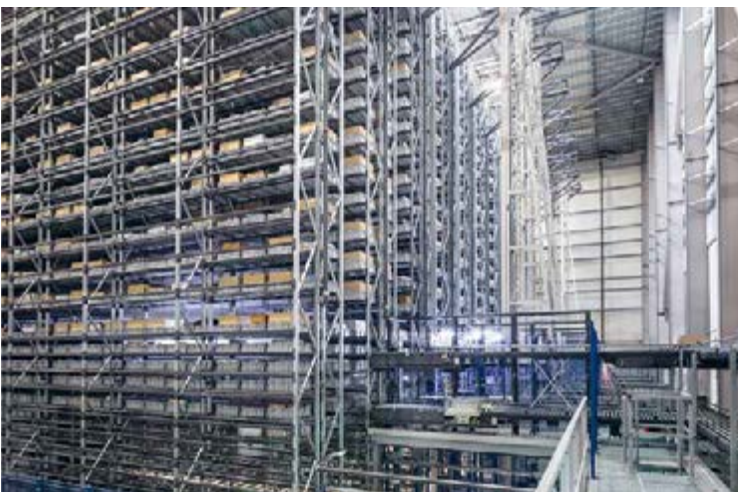
325 Logistikzentrum mit vollautomatisiertem Hochregallager von Digitec Galaxus in Wohlen, 2018. Die Entwicklung des Internets nach der Jahrtausendwende veränderte das Einkaufsverhalten der Konsumenten und damit auch den Warenfluss. Im Logistikzentrum finden auf einer Fläche von 46 500 Quadratmetern und über 100 Kilometern Regallänge bis zu 1,5 Millionen Artikel Platz für den Online-Versand.
