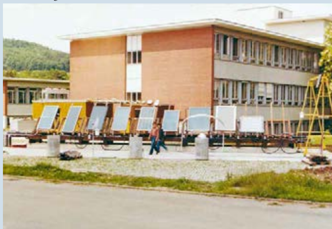
309 Ein ungewohntes Bild bot sich Mitte der 1970er-Jahre im EIR Würenlingen: Im Herzen der Kernenergieforschung stand ein Freiluft-Prüfstand für Kollektoren. In der Abteilung Physik befasste sich eine Gruppe damit, Anlagen zu testen. Damit legte sie Grundlagen zur Akzeptanz und Normung von Sonnenenergie.
