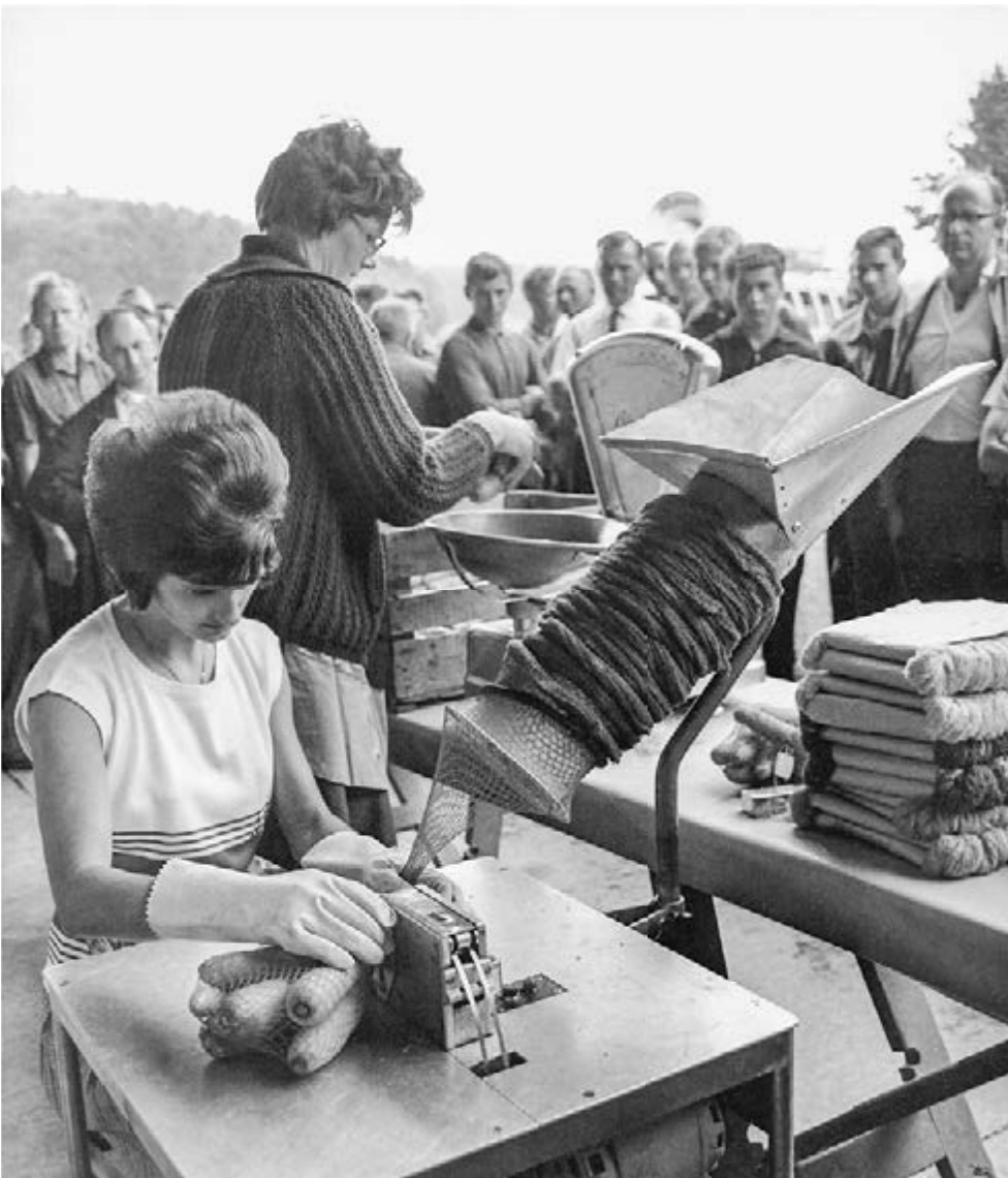
249 Rationelles Gemüseverpacken im Murimoo, 1964. Der Aargauische Gemüseproduzentenverband liess Bäuerinnen zeigen, wie Gemüse marktgerecht zu verpacken war. Die «Rüebli» wurden exakt abgewogen, über einen Trichter in ein Plastiknetz gefüllt, das dann mit einer Metallklammer verschlossen wurde.
